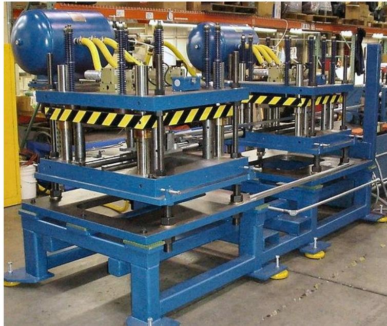
板材成形是现代工业中的一种重要金属加工技术,具有尺寸精度高、生产效率高和材料利用率高等优点,应用极其广泛。但是,高强度钢板材料性能与普通钢板相比有很大的差别,主要表现在高强度板的总伸长率小。冲压成形时,其材料流动难以控制,薄板的应力和应变分布不均,容易产生深冲裂纹、起皱、回弹大且成形精度难以控制。
